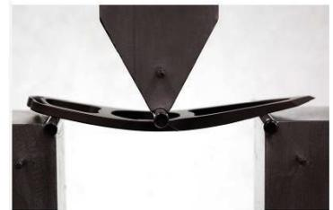
Altra caratteristica del **BMG** è la presenza della temperatura di transizione vetrosa proprio come i vetri tradizionali, infatti come è possibile controllare la viscosità del vetro lo è anche per il **BMG**, questo rende possibile la lavorazione o modellazione del materiale tra i 280°C. e i 320°C.
