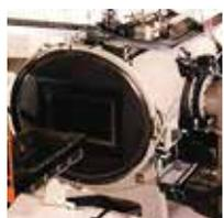
Dal 1982 si dedica esclusivamente al trattamento termico sottovuoto. Partner ideale per la soluzione delle problematiche connesse al trattamento termico. Forni sottovuoto orizzontali con spegnimento in gas, pressurizzabili e in grado di raggiungere alte velocità di raffreddamento. Cicli automatici e ripetibili con estrema precisione e affidabilità.
